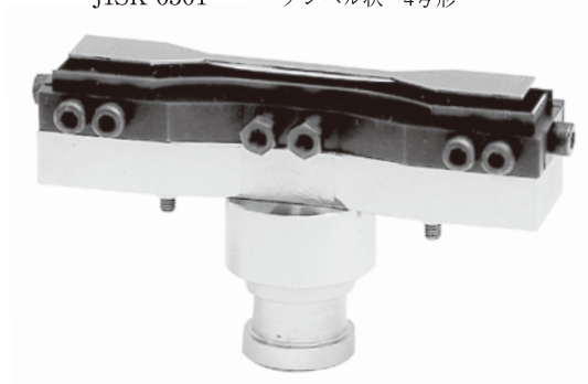
SDMK-1000 加硫ゴム引張試験片用 JISK-6251 ダンベル状 6号形 BS-6746 ISO 37-2
