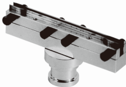
SDMK-1000 加硫ゴム低変形応力試験片用 ASTM-D-1329 JISK-6254
