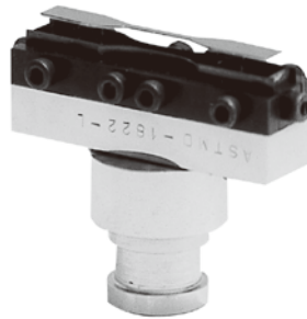
SDMK-1000 加硫ゴム低変形応力試験片用 ASTM-D-1329 JISK-6254
