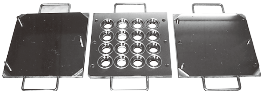
MPL-316L 加硫ゴム圧縮永久ひずみ試験用金型 JISK-6262 大型試験片 成形数 16個取り
