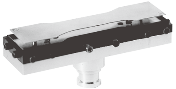
SDMK-1000 引張試験片用 BS-6746 IEC-540(L) DIN-53504-S2
